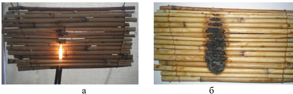
Рисунок 3. Результати випробувань очерету вогнезахисного спучуючим покриттям: а – вплив полум'я пальника на очерет; б – утворення на поверхні горючої речовини теплоізолювального шару піно коксу
